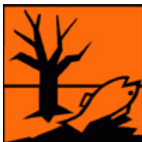
N Peligro para el medioambiente
