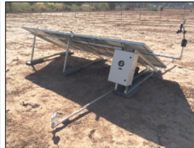
Imagen 10 – Estación de pruebas de 1[kWp] instalado en la planta fotovoltaica de Subsole en Copiapó.
