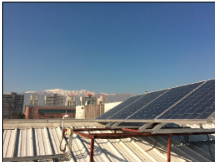
Imagen 9 – Estación de pruebas de 1[kWp] instalado en la Universidad Técnica Federico Santa María.
